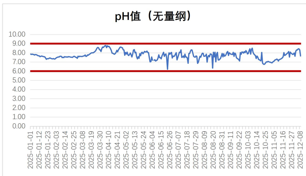
图 3.5-8 废水在线监控图（横坐标为监测时间，纵坐标为 pH）
