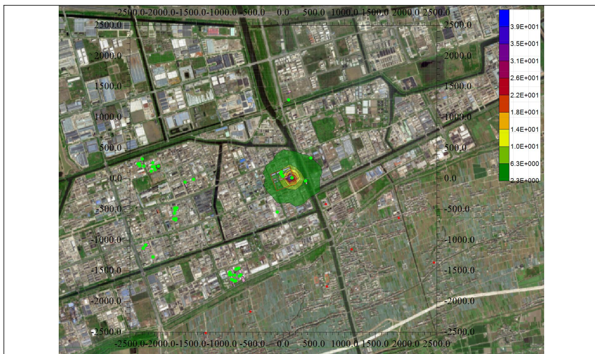
图 6.2-19 乙酸乙酯 1 小时最大落地浓度分布图
